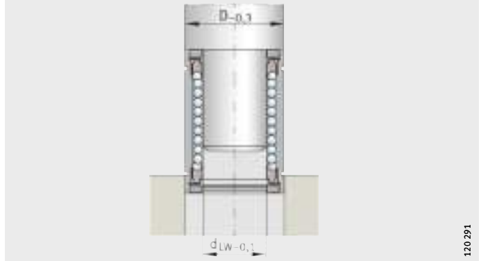
Figura 2 Montaje de rodamientos lineales a bolas con un punzón-guía
